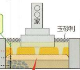
※2~3カ所、水抜き用の通り道を作成して下さい。
